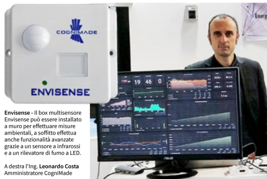
**Envisense** - Il box multisensore Envisense può essere installato a muro per effettuare misure ambientali, a soffitto effettua anche funzionalità avanzate grazie a un sensore a infrarossi e a un rilevatore di fumo a LED.
