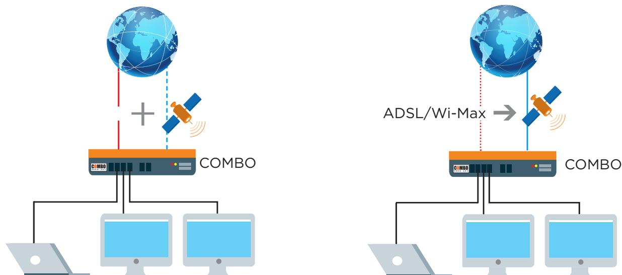
In caso di traffico intenso il router COMBO, opportunamente programmato, ripartisce e bilancia il traffico dati, mettendo a disposizione degli utenti la somma della capacità complessivamente disponibile delle due connessioni, riducendo così la congestione. In caso di caduta o intermittenza del segnale di una delle connessioni viene sempre assicurata la continuità di servizio in modo fluido ed automatico.
