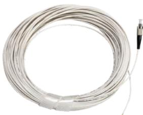
Semibretella monofibra da 2 mm G657.A (Bend Insensitive) terminato solo da un lato FC-PC da punto presa verso STOA. N.B. utilizzabile con presa/ricevitore cod. 431501 e 451503
