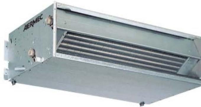
Il **ventilconvettore** con motore inverter modula la velocità dei ventilatori in continuo, fornendo l'esatta energia richiesta dall'ambiente molto più efficacemente di un terminale a 3 velocità.
