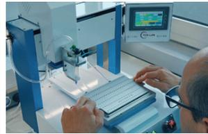
Robot automatico per resinatura ferule ottiche
